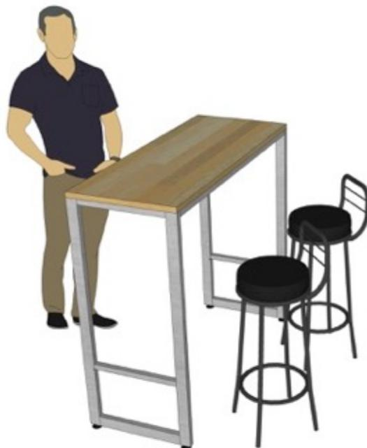
Dimensiones generales: 50 centímetros de ancho por 183 centímetros de largo y 110 centímetros de alto.
