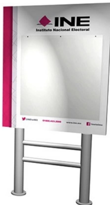
Trovicel o Sintra, de 6 milímetros de espesor, fijo en ambos lados del marco con cinta transparente doble cara tipo o similar a VHB 3m de 3/4 de pulgada de ancho por 1 milímetros de espesor, aplicado a todo lo largo de los postes y travesaños que forman el marco.
